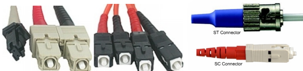
Gambar 2.13. Konektor dan kabel Fiber Optic
