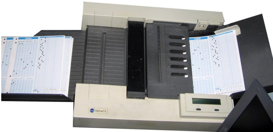
Gambar 4.3 Scanner Automatic Document Feeder untuk mengoreksi LJK
