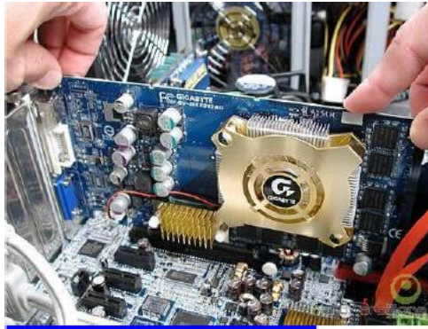
(Gambar 1.7) pemasangan card adapter langkah pertama.
