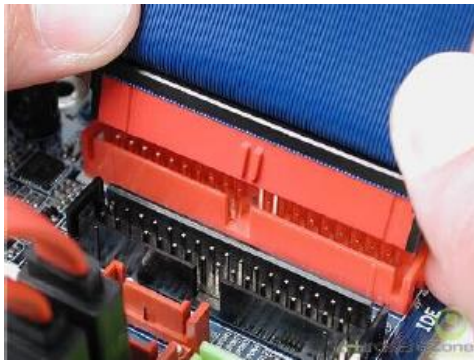
(Gambar 1.6) Langkah pemasangan setiap drive
