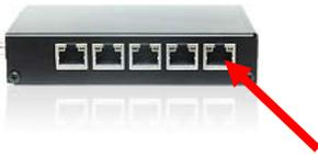
Port ethernet pada Mikrotik RB450 ada 5 ether
