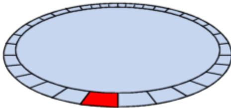
13.4. Gambar 4. Sektor yang membentuk trak (gambar dari <http://en.kioskea.net/contents/626-formatting-formatting-a-hard-drive>)
