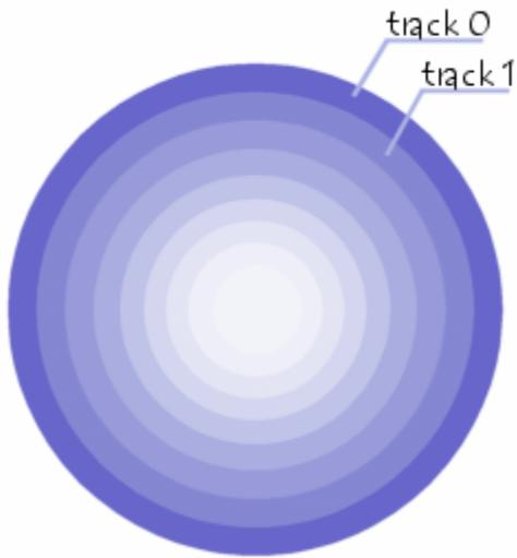
13.3. Gambar 3. Trak pada harddisk dimulai dari trak 0 (gambar dari <http://en.kioskea.net/contents/626-formatting-formatting-a-hard-drive>)
