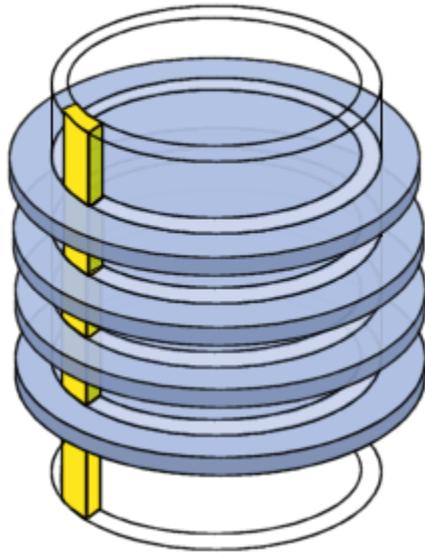
13.5. Gambar 5. Silinder yang membentuk partisi (gambar diambil dari <http://en.kioskea.net/contents/626-formatting-formatting-a-hard-drive>)
