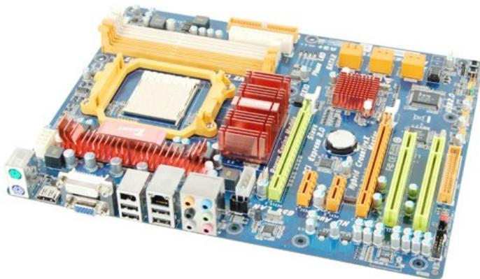
Motherboard juga dikenal sebagai sistem board atau papan utama (main board). Semua hal dalam sistem yang terhubung dalam komputer, dikontrol atau dikendalikan oleh motherboard untuk berkomunikasi dengan peranti yang lainnya dalam sistem. Sistem board adalah papan sirkuit tercetak (printed circuit board)
