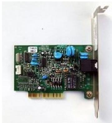
ditunjukkan dalam Gambar . CNR adalah interface 30-pin yang mengakomodasi dua format dan membuat variasi audio/modem dan audio/network menjadi mungkin dilakukan.
