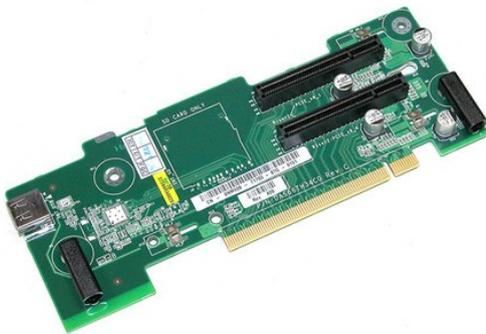
, digunakan ketika komputer di-load penuh. Secara fisik akan menambah slot sehingga chip ataupun kartu dapat di plug. Dalam tampilan sederhana, case yang hemat tempat, kartu diplug ke dalam kartu riser yang terletak paralel dengan motherboard.
