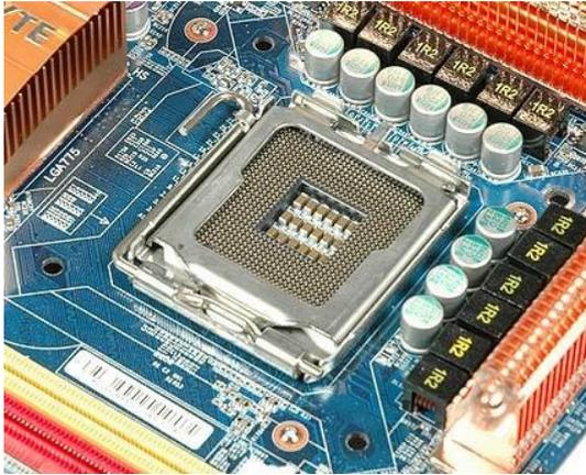
Prosesor tipe-socket menggunakan socket Zero Insertion Force (ZIF). Soket ZIF didesain untuk mempermudah memasukkan mikroprosesor. Soket ZIF memiliki tuas yang akan membuka dan menutup untuk mengamankan mikroprosesor di tempatnya. Sebagai tambahan, soket yang memiliki nomer berbeda akan memiliki pengaturan pin dan pin lay out yang berbeda pula. Misalnya, Soket 7 memiliki 321 pin. Jumlah pin akan semakin meningkat seiring dengan penomoran soket.
