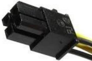
Konektor 4-pin 12V (P4) dan konektor 8-pin 12V (EPS) digunakan untuk memberikan daya khusus kepada prosesor. P4 mulai digunakan pada motherboard untuk prosesor pentium 4 sehingga disebut P4. Fungsi dari konektor ini adalah sebagai penyedia tenaga tambahan sebesar 12 V untuk Prosesor Pentium 4. Konektor EPS biasa digunakan untuk motherboard server.
