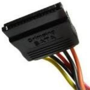
Konektor ini digunakan khusus untuk komponen yang menggunakan interface SATA, misalnya harddisk. Konektor ini memiliki 3 tegangan, yaitu +3,3V, +5V, dan +12V.
