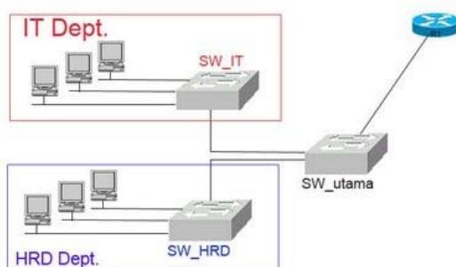
Gambar 1. Topologi VLAN dengan Router
