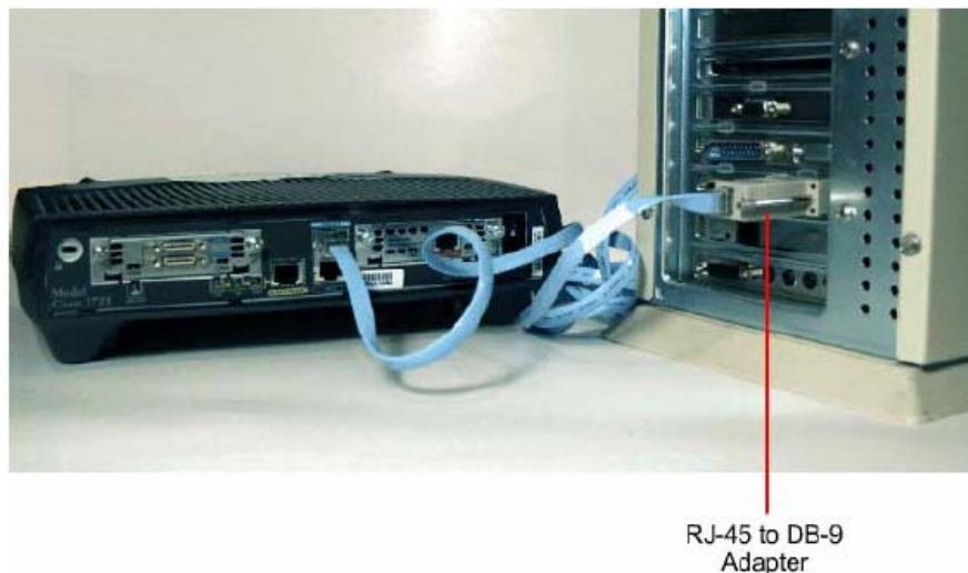
1. Hubungkan kedua PC pada serial port dengan Router pada interface “console” menggunakan kabel console.
