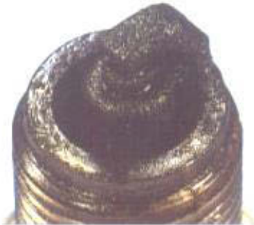
Gambar 2.51: isolator dan elektroda sangat kotor
