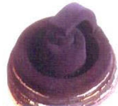
Gambar 2.50: isolator dan elektroda - elektroda berjelaga
