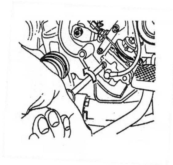
Gambar 3.29: pengerasan baut penyetel pompa oli
