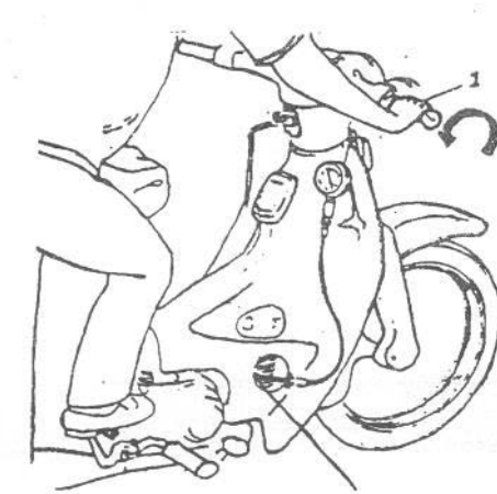
Gambar 1. 17: kabel gas tarik penuh (tanda panah)
