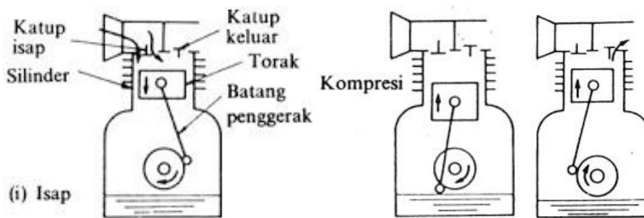
Gambar 16. Cara Kerja Kompresor Kerja Tunggal
