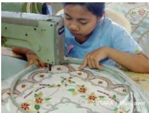
Gambar 1.49 Teknik bordir dengan menggunakan mesin jahit
