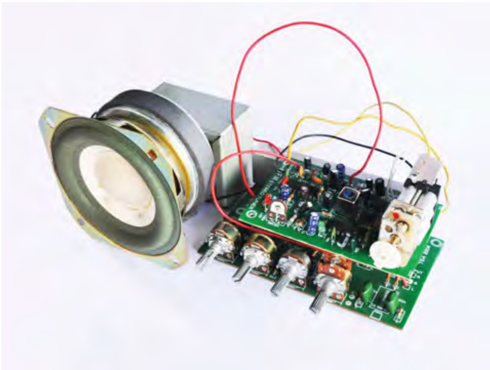
Gambar 2.18 Rangkaian radio dengan speaker dan tombol-tombol putar pengatur suara serta pencari gelombang
